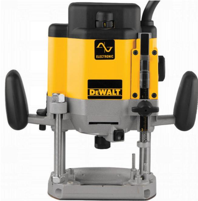
**CARACTERISTICAS** Motor electrónico de velocidad variable funciona a 8,000-22,000 rpm Regulador de profundidad de cremallera y piñón Bujes de bronce fosforado Collets de 1/4" a 1/2" para mayor versatilidad Base con adaptador de guías estándares para trabajo de copias Eje del motor de una pieza
