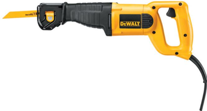
Mordaza de 4 posiciones permite cortes al ras de la superficie Potente motor de 10 Amp Liberador de mordaza sin llave para cambios fáciles y rápidos de la cuchilla Velocidad variable de 0-2,800 cpm y longitud de carrera de 1-18" (29mm) para cortes más rápidos Gatillo de velocidad variable para un mayor control
